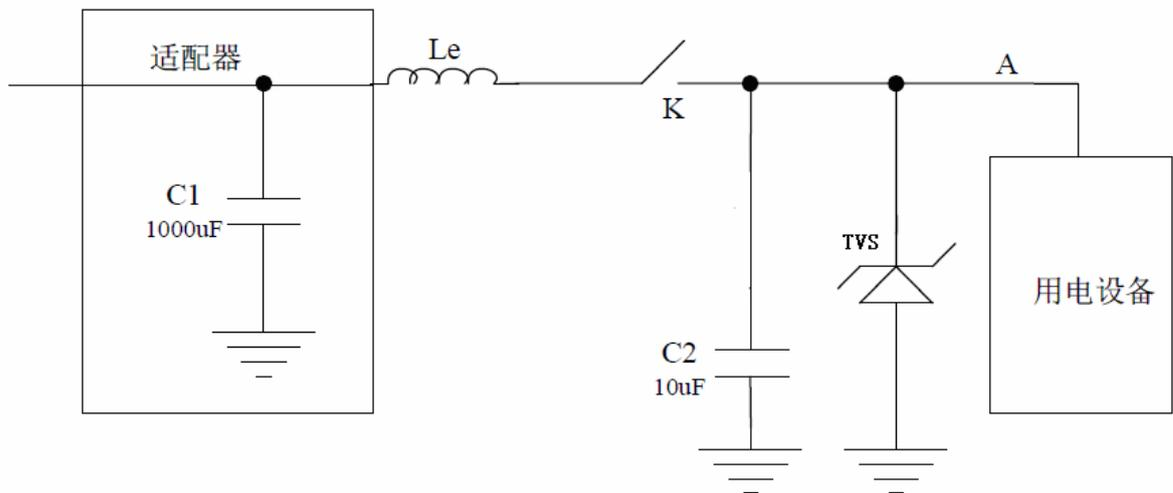
图四 并联一个瞬态电压抑制器电路
