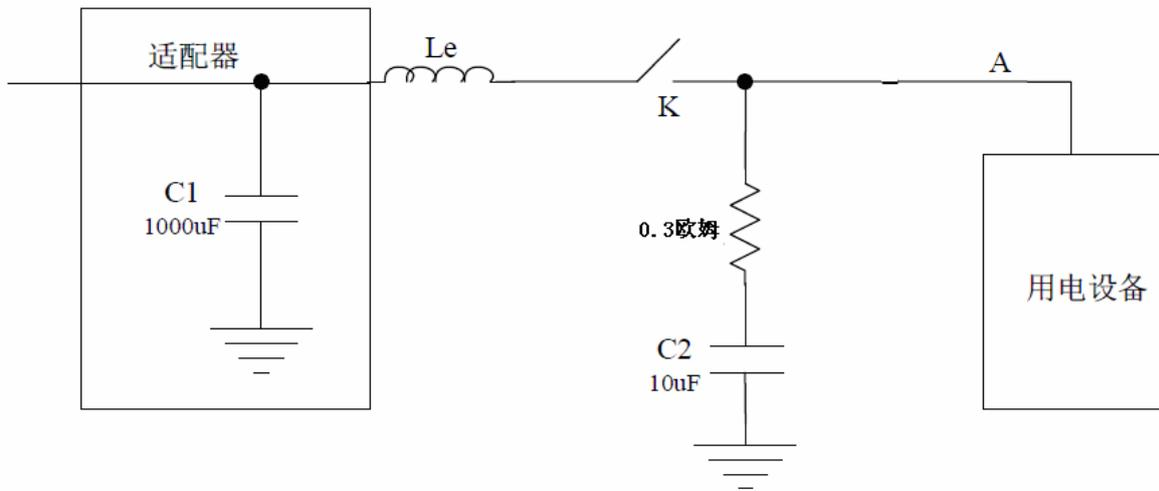
图三 陶瓷电容串联一个电阻电路
