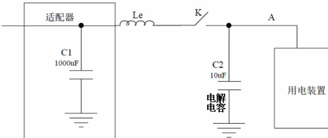
图二  $C2$ 使用电解电容电路
