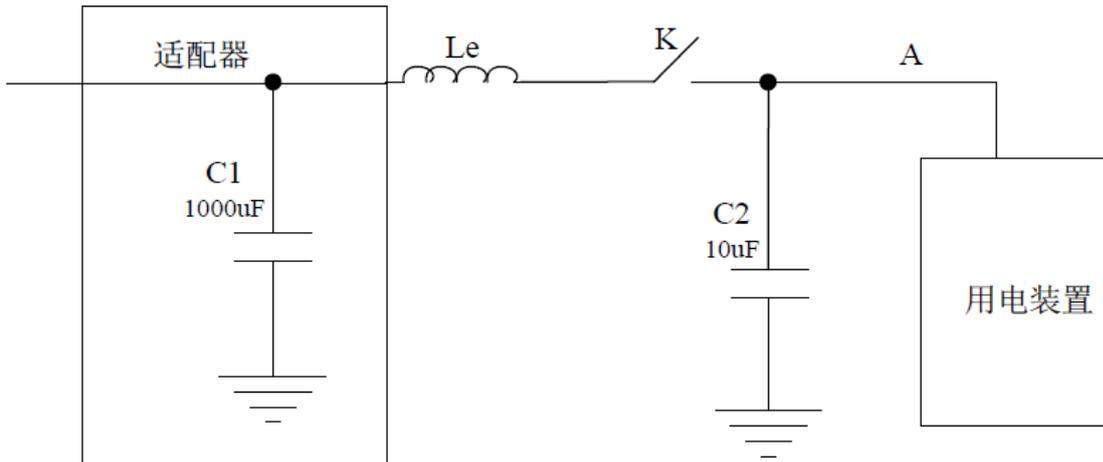
图一 输入滤波电容引起问题电路
