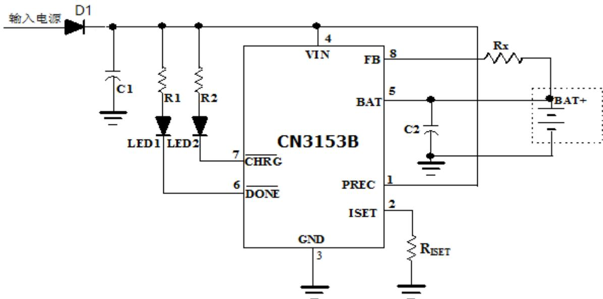
图6 增加二极管抑制过冲电压
