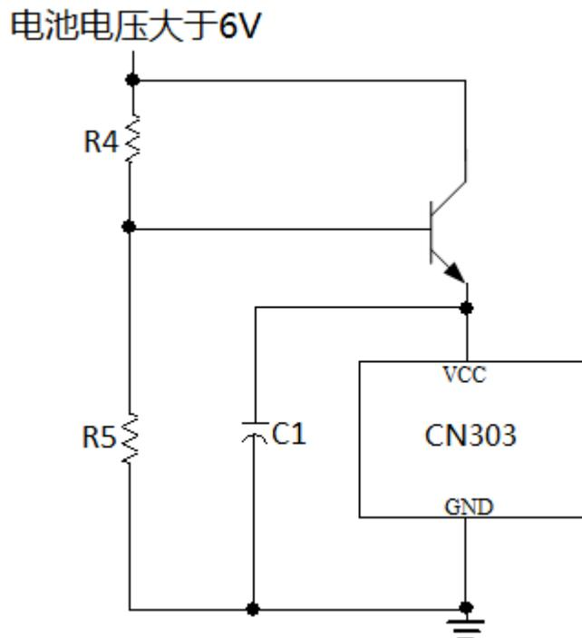
图6 通过电阻分压产生CN303工作电源
