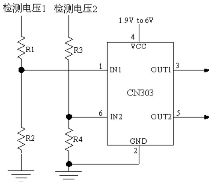
图 2 检测两个独立的电压
