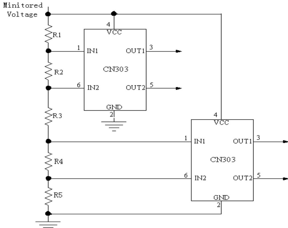
图7 利用两个CN303实现四路监测输出
