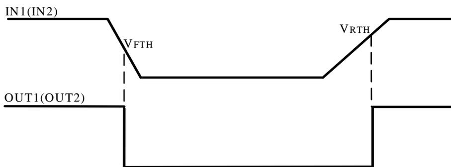
图4 CN303 的工作原理
